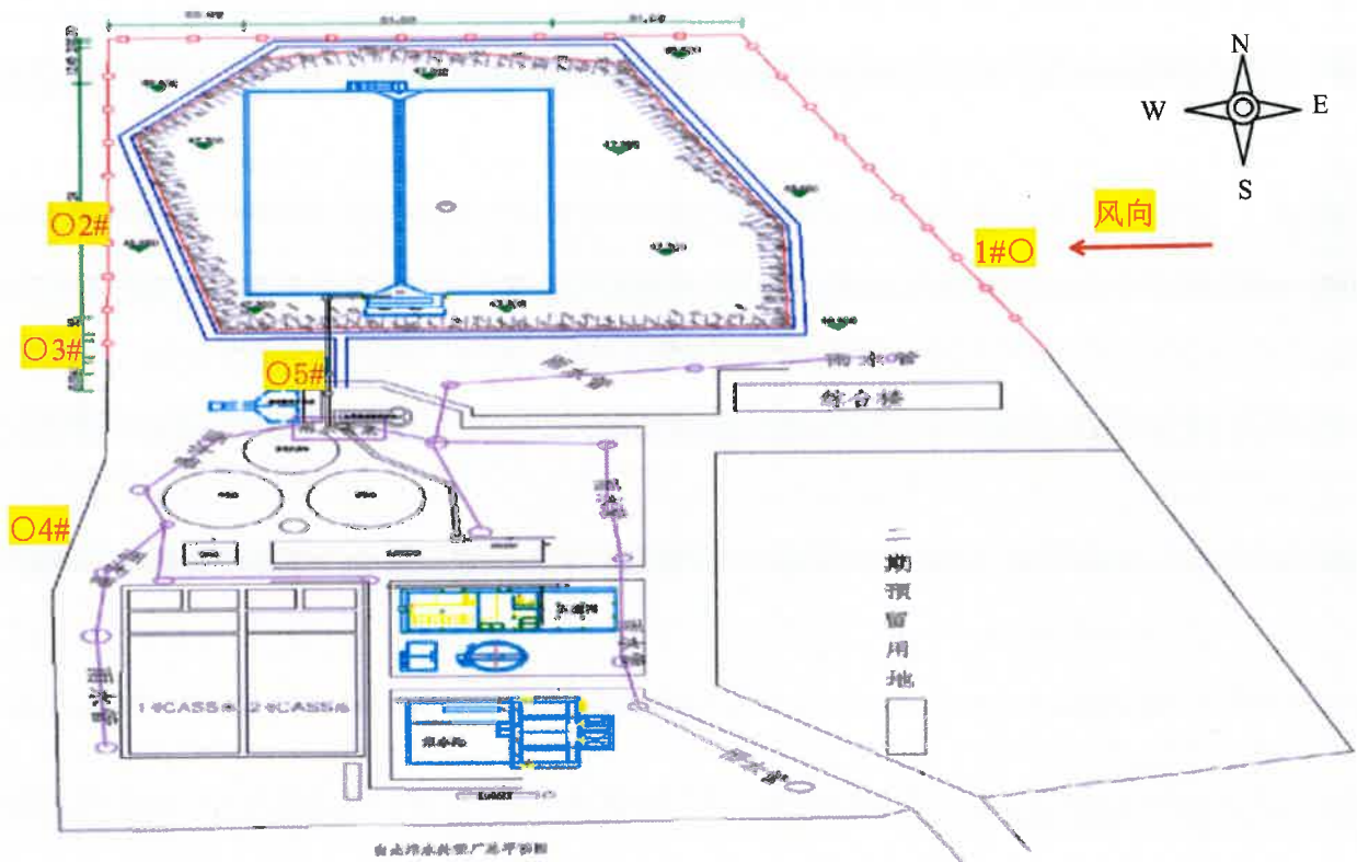
附图 1：检测布点图，“○”表示无组织废气检测点。
